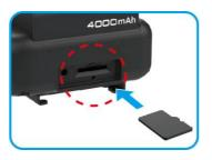
卡蓋必須密合於主機,以防止水氣進入,造成鏡頭起霧現象。可先向左插入卡槽邊缘,再壓合卡槽右邊緣。操作方式如下示意圖。
