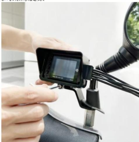
5. 整理線材。發動機車，主機開機後，利用水平支架及後照鏡支架調整主機螢幕角度之後，將支架的兩個螺絲旋緊。如有需要，可自安裝輔件包內取出理線帶，將主機端的線材束起來，完成安裝。
