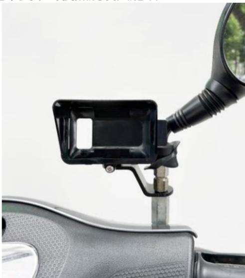
3. 用六角扳手轉鬆遮光罩中間的螺絲，鬆開後螺絲會浮起，但不會脫落。再將兩邊的卡榫用手扳開，打開遮光罩。
